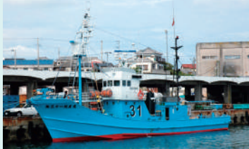
外房捕鯨の小型捕鯨船 船の長さは約25m、30t 乗組員は船長、砲手、機関員、甲板長など6人ほど 主な操業海域
