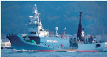
共同船舶の捕鯨船 第三勇新丸 船の長さは約70m、742t 乗組員は25人 操業海域
