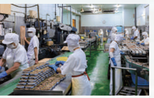
青魚の蒲焼缶詰の製造風景。焼き行程、ポイル工程のある製品を製造。鯨の缶詰も同ラインで製造している
